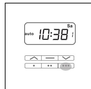
Nachdem Sie die Zeiteinstellung für die ganze Woche fertig eingestellt haben, drücken Sie "Zeitbestätigung" für 3 Sek., die Stunden und Minutenanzeige blinkt, danach sind Einstellungen gespeichert und das Menü wird automatisch verlassen.
